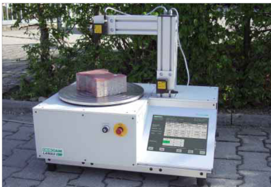
Система LAMAS 21W фирмы DESCAM определяет плотность свежееотформованных камней.
