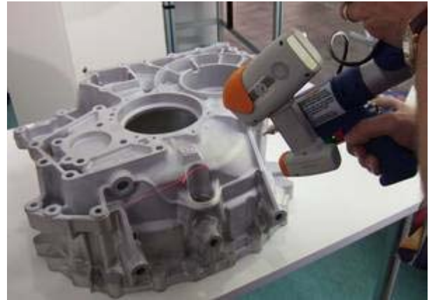
Laserscannen mit dem ModelMaker D
