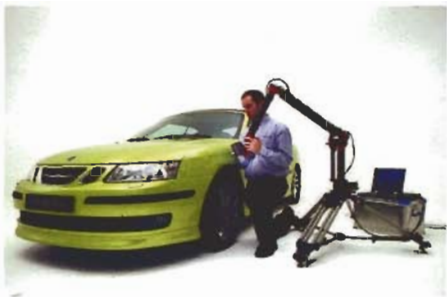
ModelMaker Z kann dank seiner hohen Beweglichkeit mit dem 7-achsigen Koordinaten-Messarm komplette Objekte in einem Mess-Ablauf erfassen, auch Automobile in Original-Größe.
