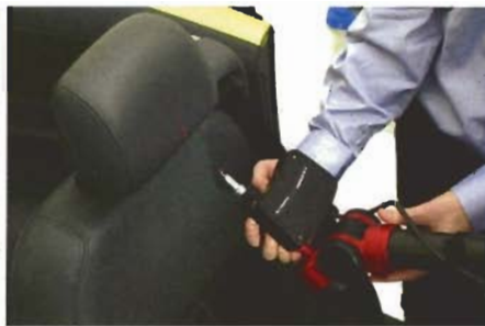
ModelMaker Z kann dank seiner hohen Beweglichkeit mit dem 7-achsigen Koordinaten-Messarm komplette Objekte in einem Mess-Ablauf erfassen, auch Automobile in Original-Größe.
